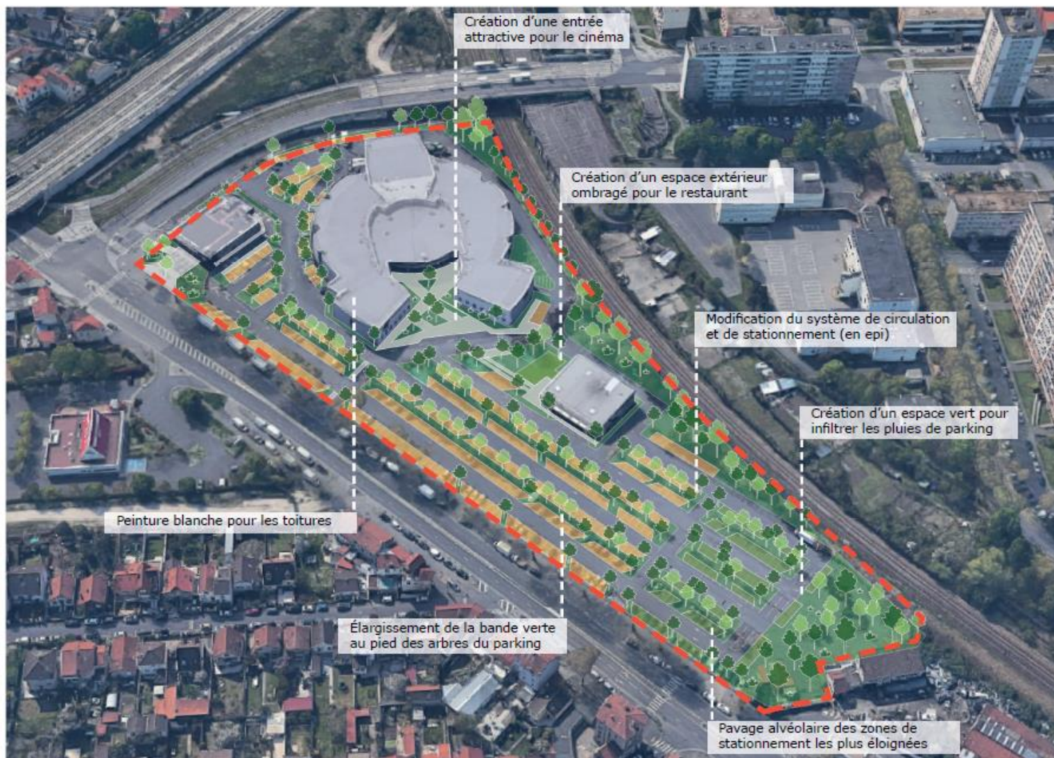
Le site après le projet - Urbanwater
