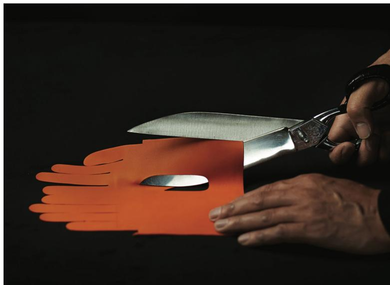
■ Gantier en train de découper aux ciseaux le cuir d'un gant, Ganterie Causse Gantier à Millau (Aveyron)
