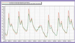
Analyse du confort d'été par simulation thermique dynamique (STD)
